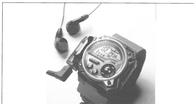
Ryc. 6. Odtwarzacz plików dźwiękowych wbudowany w zegarek elektroniczny
