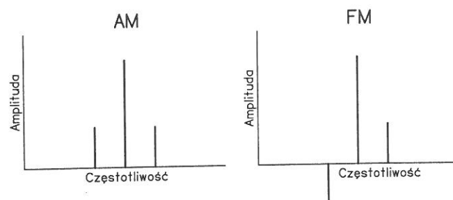
Ryc. 4. Schematyczne przedstawienie widm sygnałów zmodulowanych amplitudowo (AM) i częstotliwościowo (FM). W przypadku małych wartości wskaźników modulacji, m i \beta , widma te różnią się fazą dolnej składowej, co w postaci prążka skierowanego ku dołowi wykreślono dla sygnału FM
